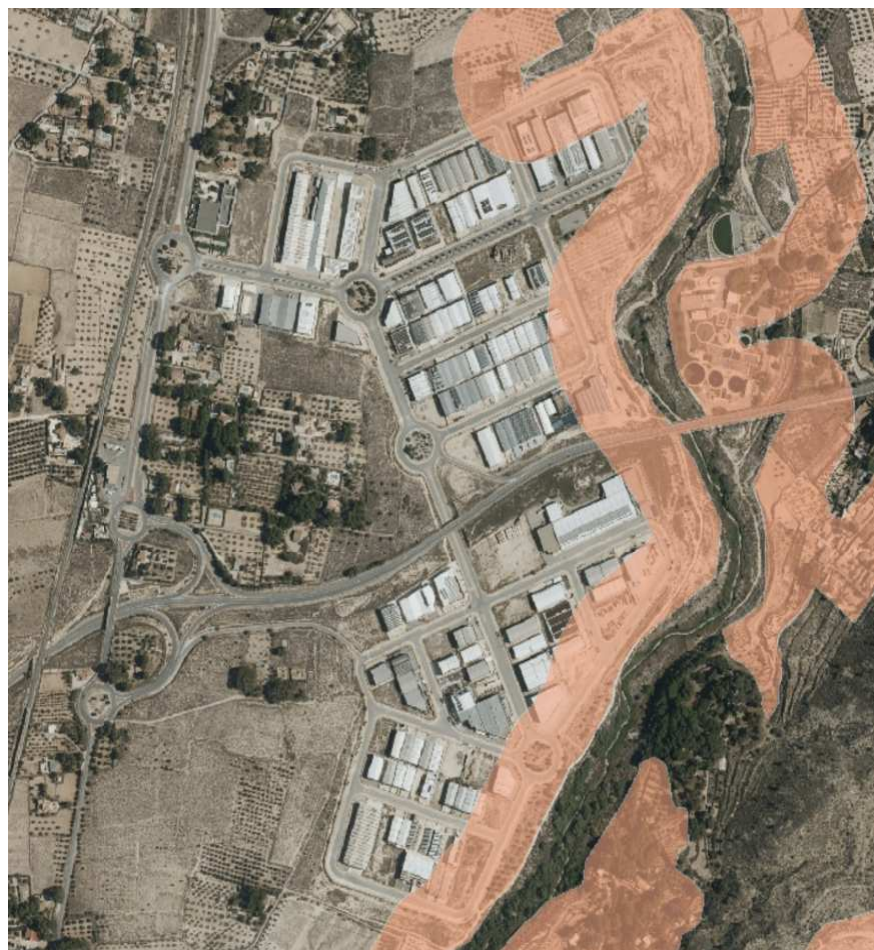
Figura 50. Afección por riesgo de incendio forestal (en naranja) del polígono, al estar a <100 m de monte
